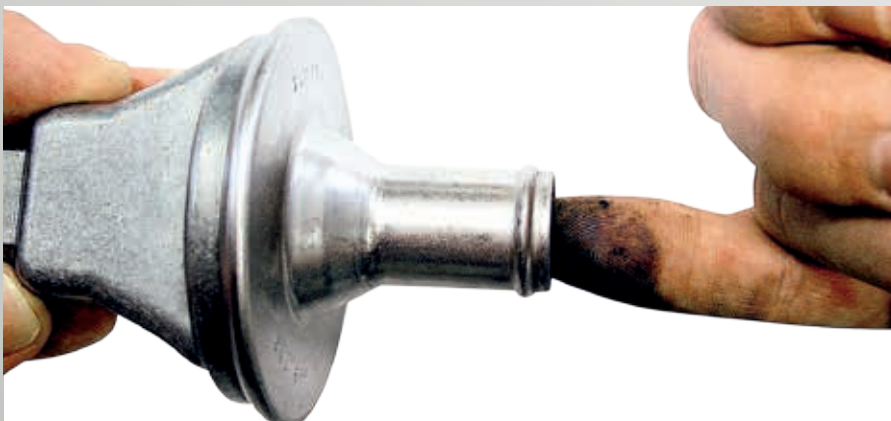
Abb. 32 Einfache Prüfung des Rückschlagventils
