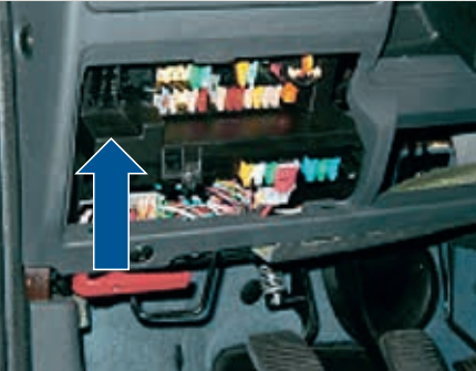
Abb. 9: Beispiele für Einbauorte von Diagnosesteckdosen"
