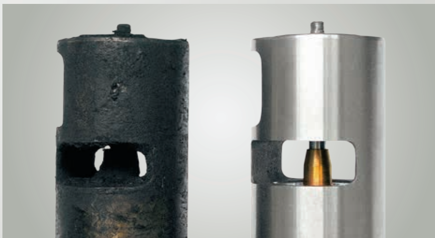
Abb. 38 AGR-Ventil (Diesel) mit starken Ablagerungen und im Neuzustand
