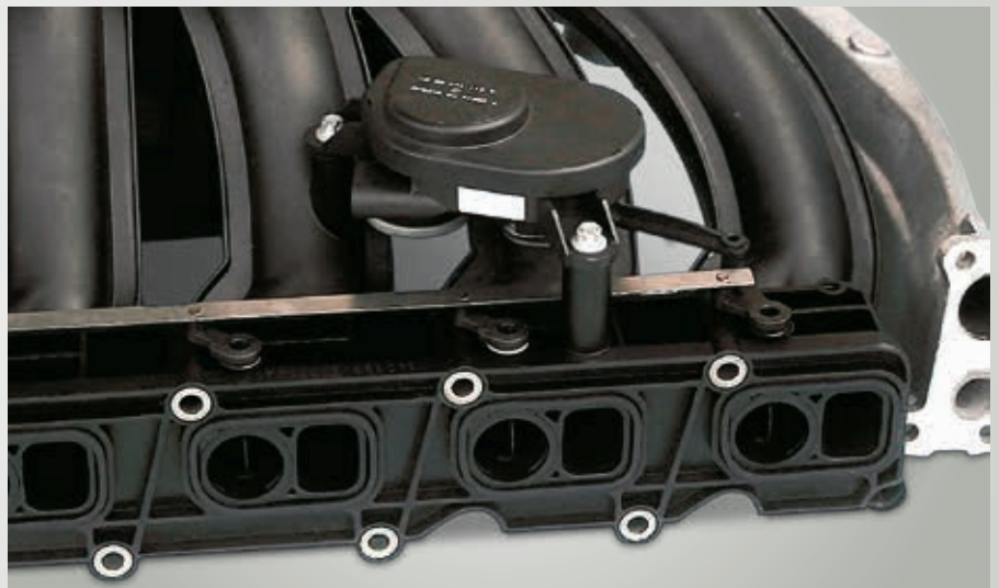
Abb. 41 Saugrohr mit Tumbleklappen und EAM-i
