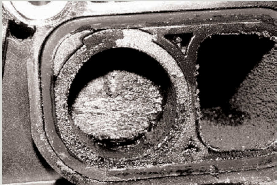
Abb. 44 Tumbleklappen, ausgefallen wegen starker Ablagerungen
