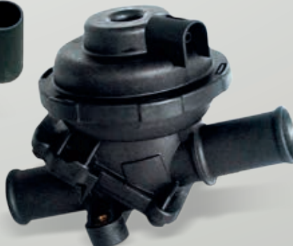
Abb. 24 Abschalt-Ventil (AV), ältere Ausführung
